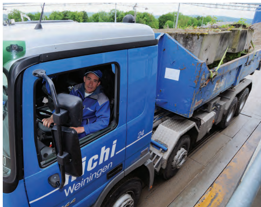
Anlieferung von Rückbaumaterial: Darunter können sich auch grosse Betonbauteile befinden, die vor der Weiterverwertung mit dem Bagger zerstückelt werden müssen.
