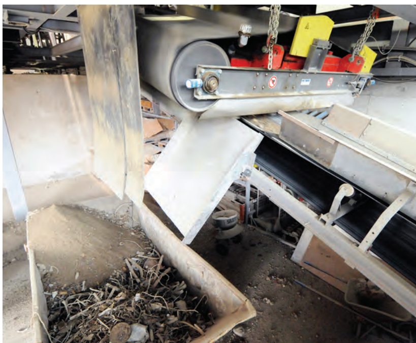
Wichtiger Aufarbeitungsschritt: Ein Abscheider nimmt störende Metallteile aus dem Material, welche später die Mahltrommel beschädigen könnten.
