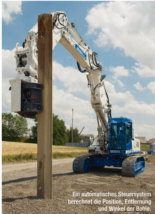
Ein automatisches Steuersystem berechnet die Position, Entfernung und Winkel der Bohle.
