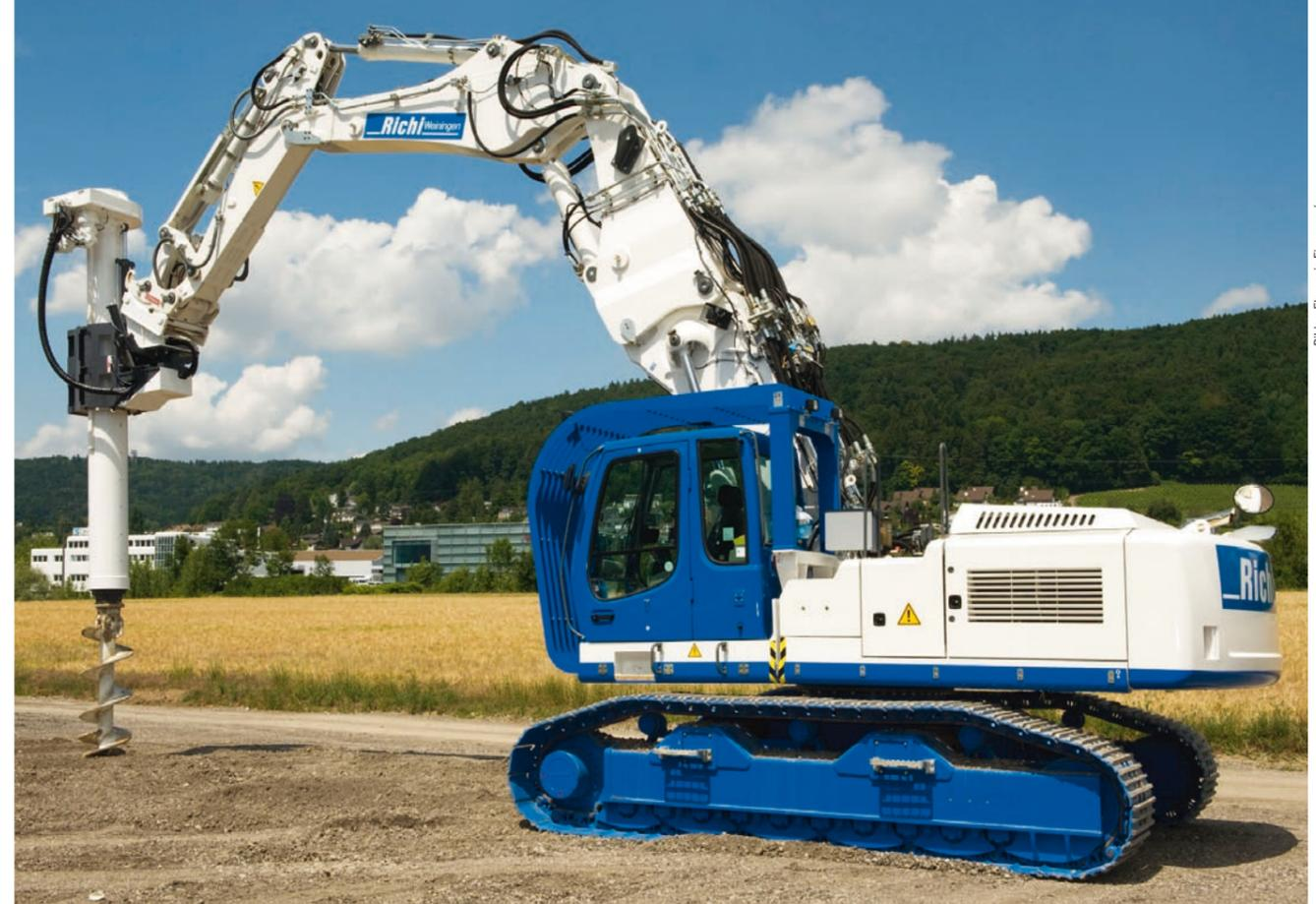
Mit der Bohrschnecke erreicht der Bagger eine Tiefe von acht Metern.
