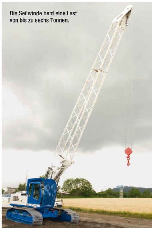
Die Seilwinde hebt eine Last von bis zu sechs Tonnen.
