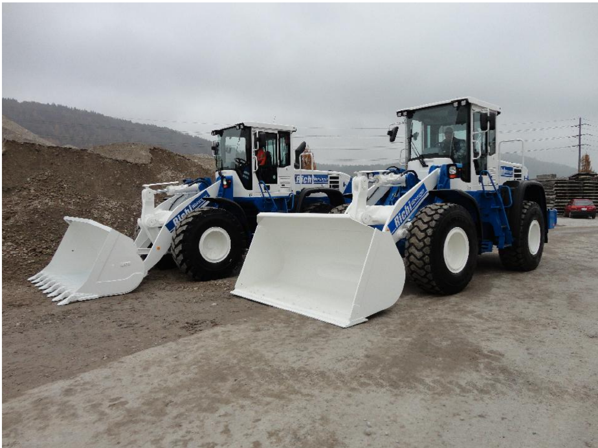
Richi Weiningen erhält zwei Hyundai HL757-9 mit 14.5 t Einsatzgewicht und 2.8 m 3 Schaufeln
