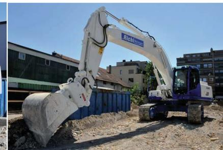
Wichtig ist Jakob Richi die Ausrüstung des neuen Raupenbaggers. So verfügt der Schwenkmotor über einen Tiltrotator und die Anbaugeräte können dank dem Schnellwechselsystem Oil Quick sehr schnell ausgetauscht werden.
