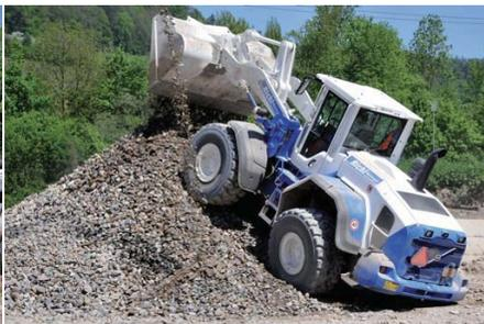
Im Kies- und Betonwerk von Richi in Weiningen wird der neue Volvo-Radlader L120G mit einem Einsatzgewicht von rund 20 Tonnen für die Aufgabe der Zuschlagstoffe eingesetzt.
