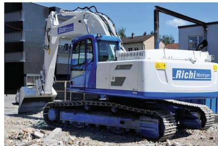
Der neue Volvo-Raupenbagger EC 300 DL mit einem Einsatzgewicht von 30 Tonnen ist für den Schwereinsatz konzipiert.
